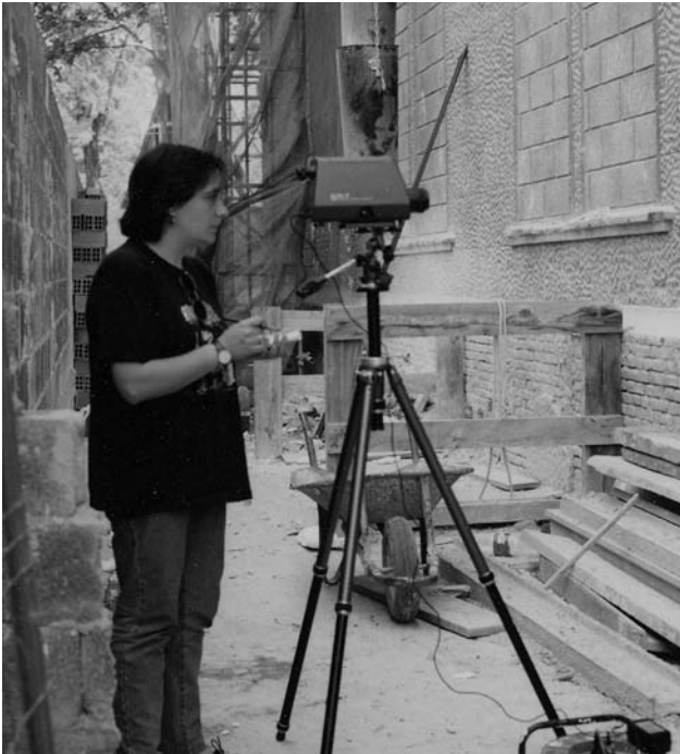
Figura 6. Lectura de las coordenadas cromáticas de la fachada del edificio
