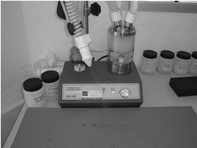
Figura 4. La consolidación de películas pictóricas mate, requiere del uso de instrumental adecuado, el vaporizador ultrasónico sirve para la aplicación de consolidantes de tipo acuoso sin necesidad de contacto con la superficie.
