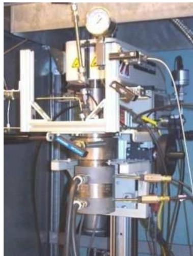
Imagen 2: Reactor para preparar materiales poliméricos
