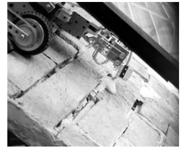
Figura 10. Ensayo de disposición de material de juntas con el robot móvil
