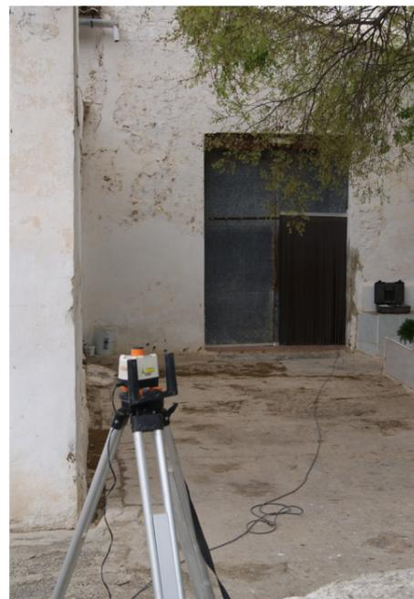
Fig. 16 Nivel láser para la toma de datos de niveles en la Alquería de Leonart. Fuente: Propio autor.
