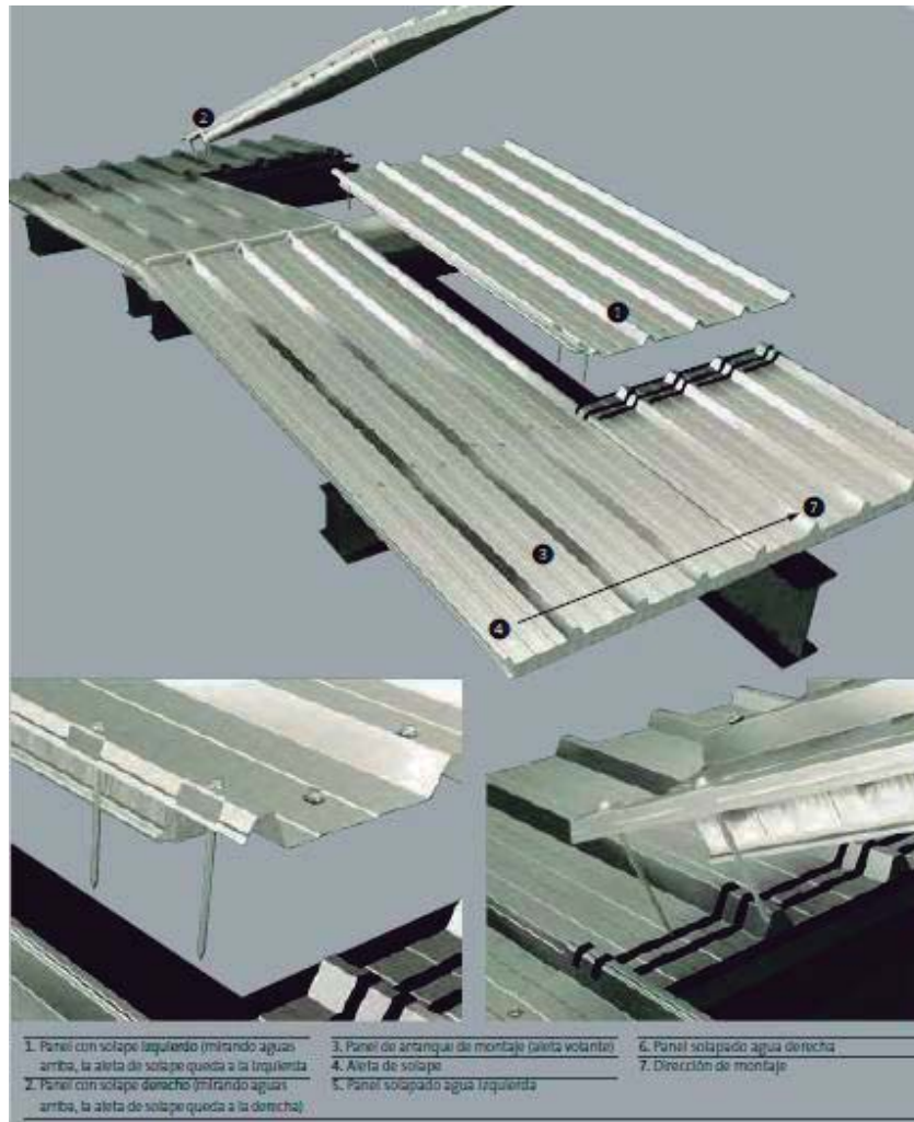
Figura 178. Montaje y solape de los paneles
