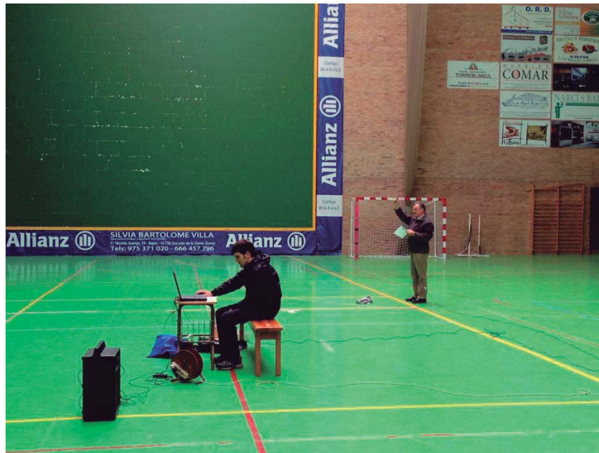
Figura 23. Medición del tiempo de reverberación
