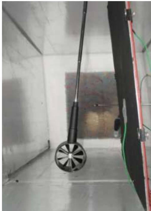
*Ilustración 21: Medidor de la velocidad del viento al lado de la placa*
