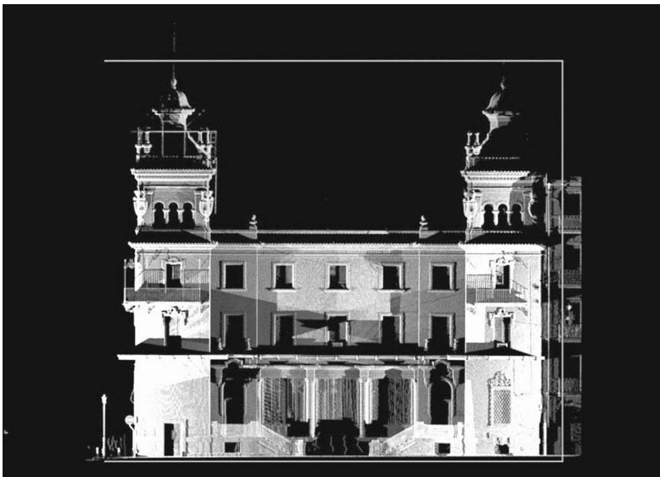
Figura 10. Imagen tridimensional del levantamiento fotogramétrico realizado
