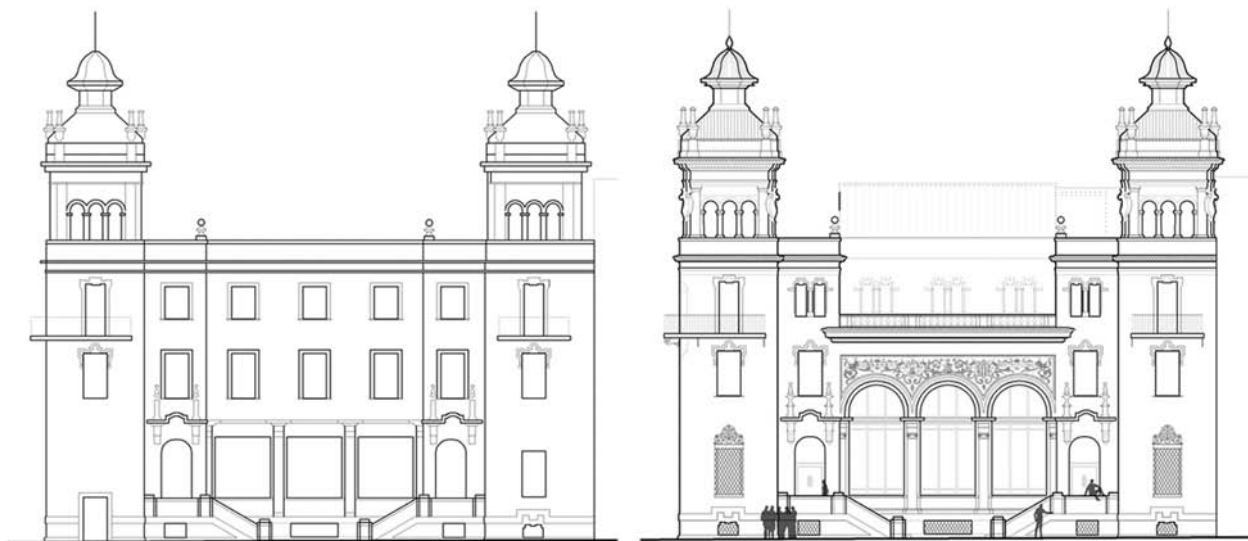
Figura 8. Comparación entre el alzado existente tras la reforma de los años 60 y la propuesta del proyecto que respeta el alzado original
