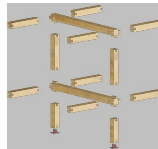
Los nudos se enlazan encajando unas piezas con otras, las cuales generan un nudo rígido al atornillar unas placas de acero para fijar el nudo.
