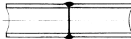
Unión de tuberías con soldadura a tope.
