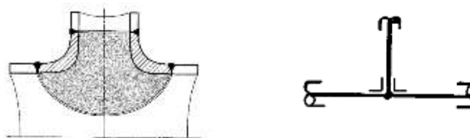
Sección conexión con “saddle” y representación del picaje para tubería con \varnothing < 12 ”.
