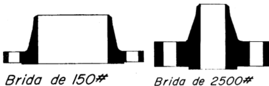
Diferencia entre bridas según su "rating".
