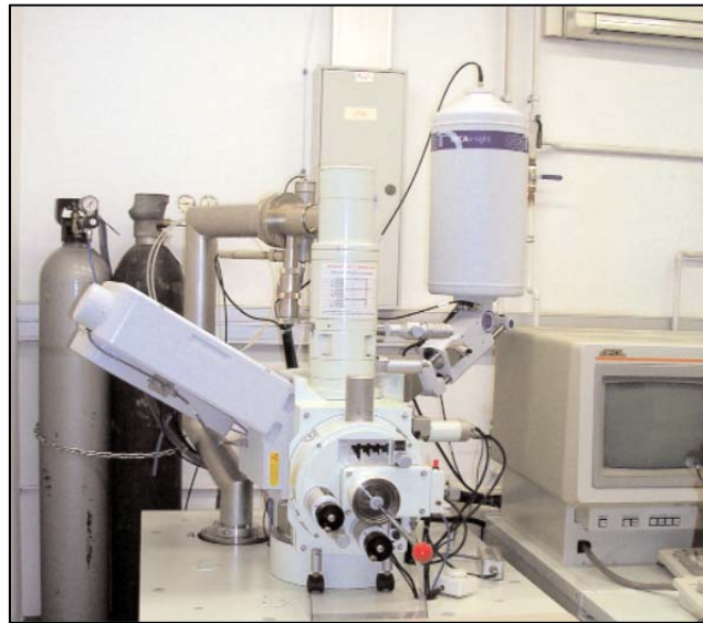
Figura 49: Microscopio electrónico de barrido. Laboratorio Universidad Politécnica de Valencia
