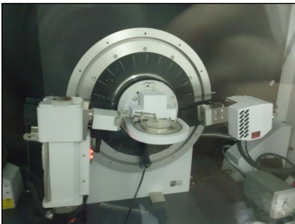
Figura 47: Difractómetro Rayos X UPV. Laboratorio Universidad Politécnica de Valencia.
