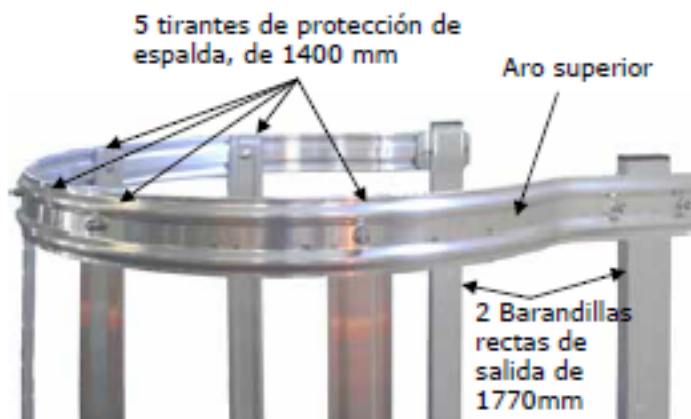
DETALLE: unión Aro superior a Barandilla recta de salida (colocar las tuercas siempre en la parte exterior del Aro)
