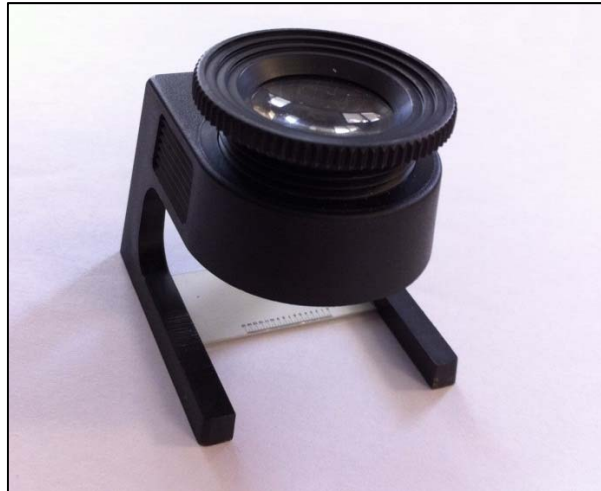
Figura 43: Medidor de grietas
