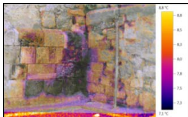
Figura 90: Superposición de la fotografía original con la realizada por la cámara termográfica
