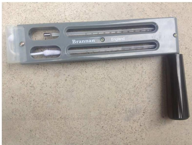
Figura 24: Higrómetro. (Fuente: Elaboración propia, 2013)
