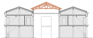
_ Con su clara división en tres partes; lleno, vacío, lleno . (Sección transversal/ escala 1:500)
