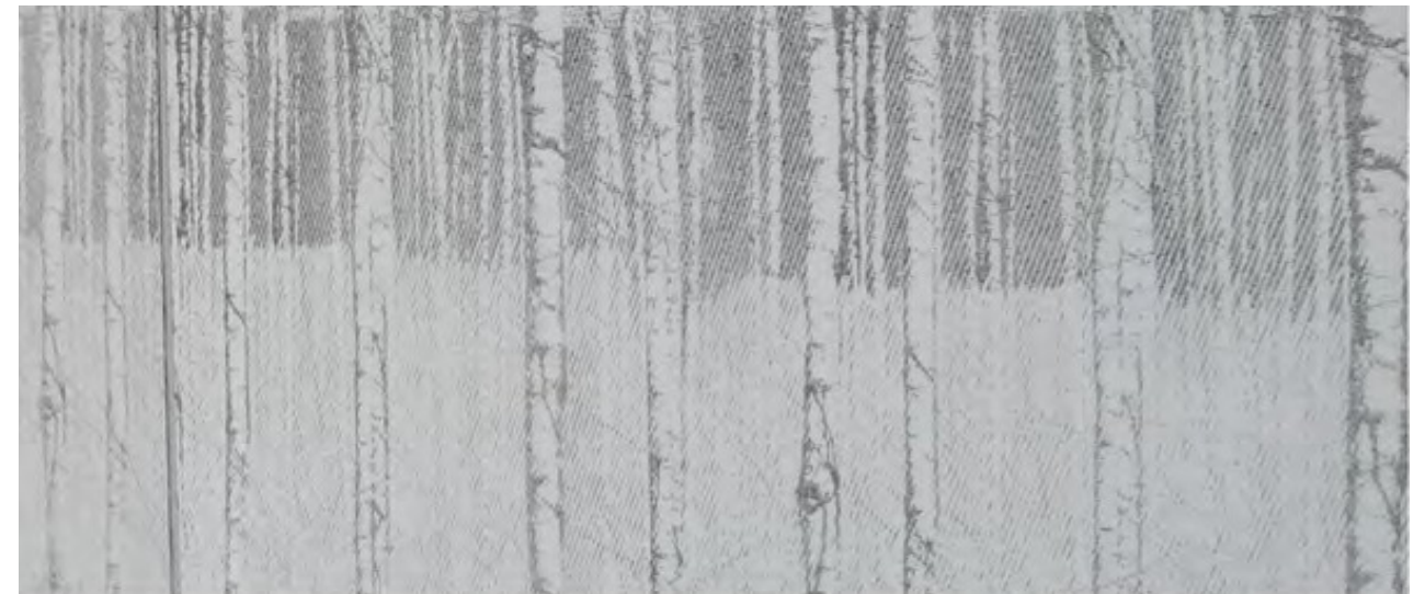
Formigó serigrafiat: Dalt, exemple d'un panell serigrafiat, esquerra, detall del serigrafiat.
