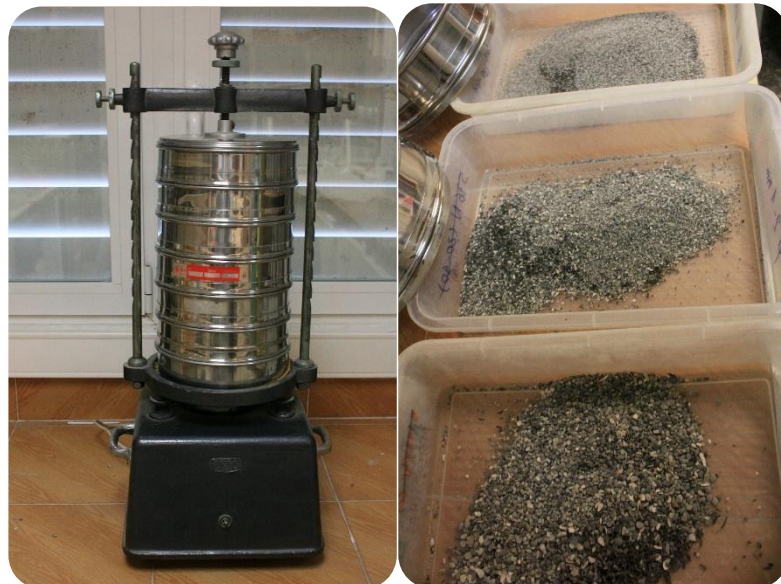
Figura 71: Torre de tamices y fracciones de arena separadas granulométricamente.
