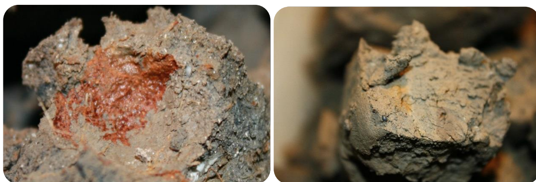
Figura 11: a) Masa de hierro oxidada y b) matriz reducida.
