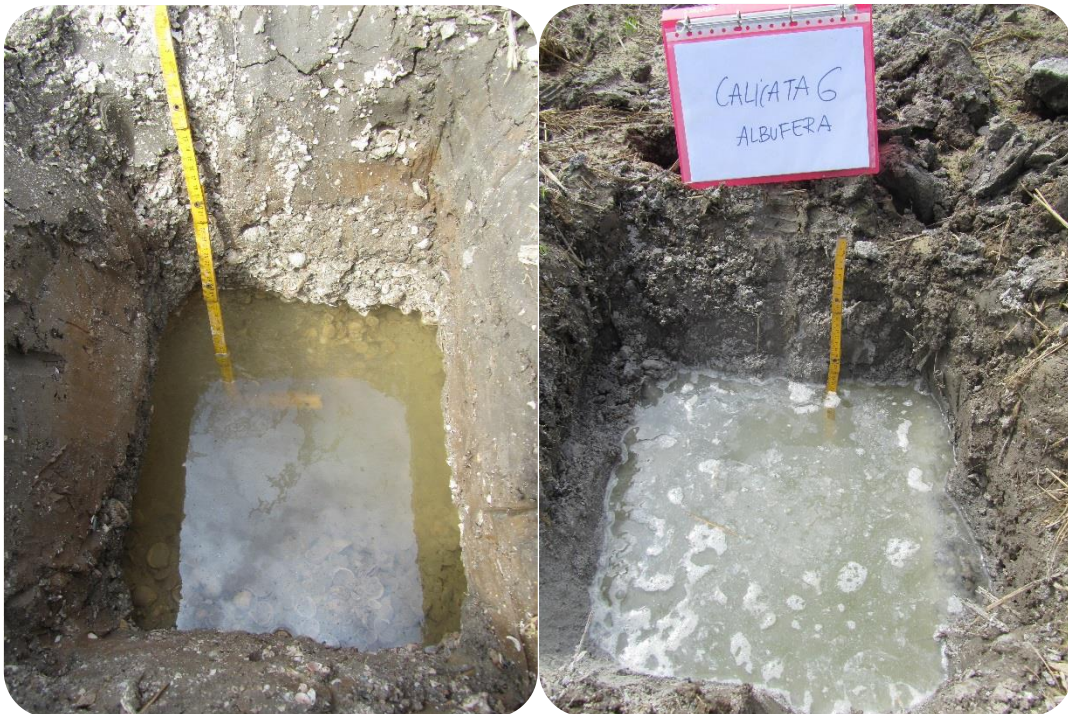
Figura 185: Capa freática cercana a la superficie en la C. 7 y C.6.
