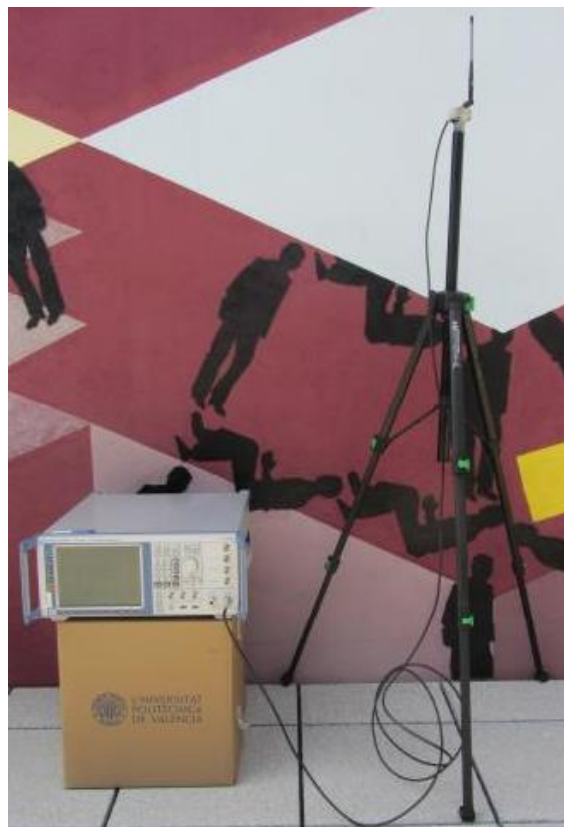
Figura 3.2: Montaje completo del Transmisor, incluyendo el aparato transmisor, el cableado y la antena en \lambda/2 .
