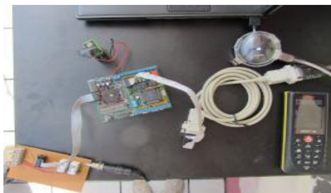
Figura 3.4: Láser de medición y mecanismo receptor.
