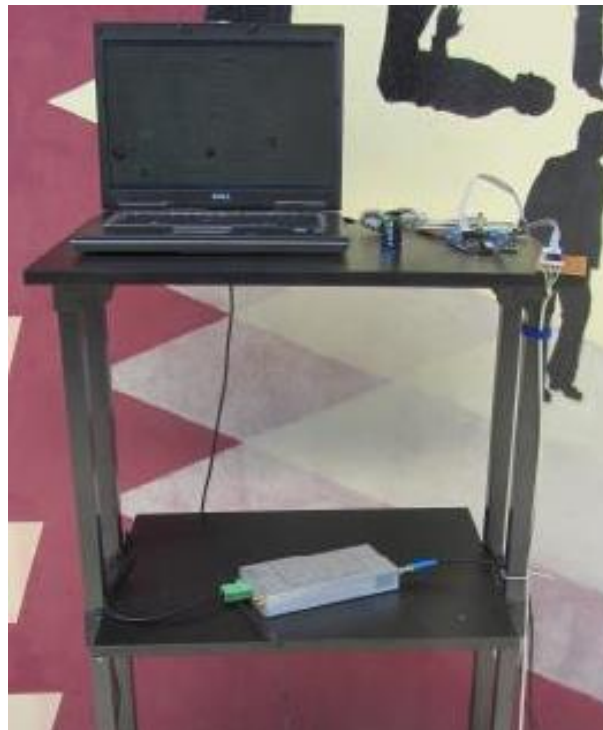
Figura 3.3: Abajo, el Teamcast DVB-T/H Diversity Demodulator, conectado al PC encargado de la gestión y captación de la señal.
