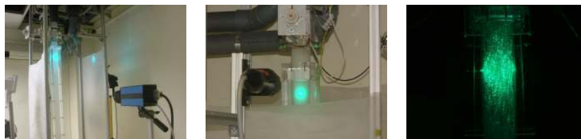
Figura 2.10 Empleo del sistema LDA en la instalación
