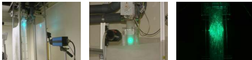
Figura 4.15 Empleo del sistema LDA en la instalación
