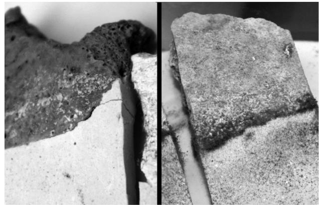
Figura 1. Detalle de la zona de unión hueso-estuco antes y después del envejecimiento artificial acelerado Ultravioleta. Izquierda probeta I76 B. Derecha probeta AL70+AC33 B
