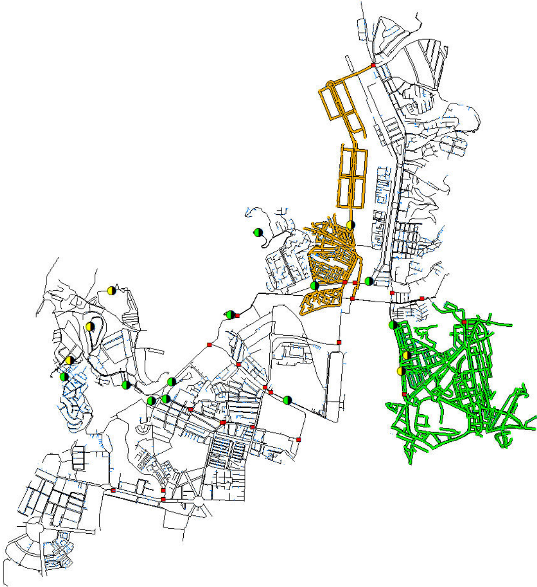
FIGURA 67. AGRUPACIÓN DE LAS DMA'S BÁSICAS 2, 3, 4 Y 5 EN DOS NUEVAS DMAS DE MODULACIÓN.
