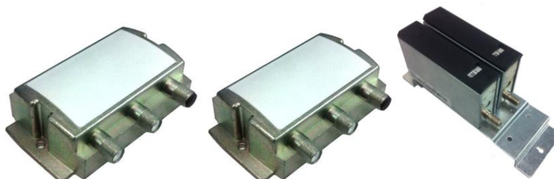
Fig. 11. Filtros de cavidades diseñados exclusivamente para este proyecto (canalización colombiana) y empleados en las medidas de laboratorio para la obtención de ACS_{\text{filtro}} y márgenes de protección. Filtros Televés 1 y 2 (izquierda y centro) y Fagor 698 LBF C.
