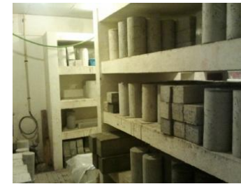
Desenfofrado y almacenamiento
