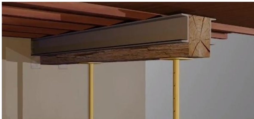
Refuerzo con perfiles metálicos en U.
