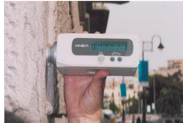
Medición con telecolorímetro y colorímetro de contacto.
