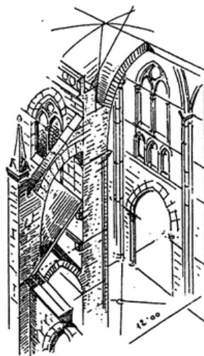
Gráfico 5.6 .Esquema trabajo estructura gótica
