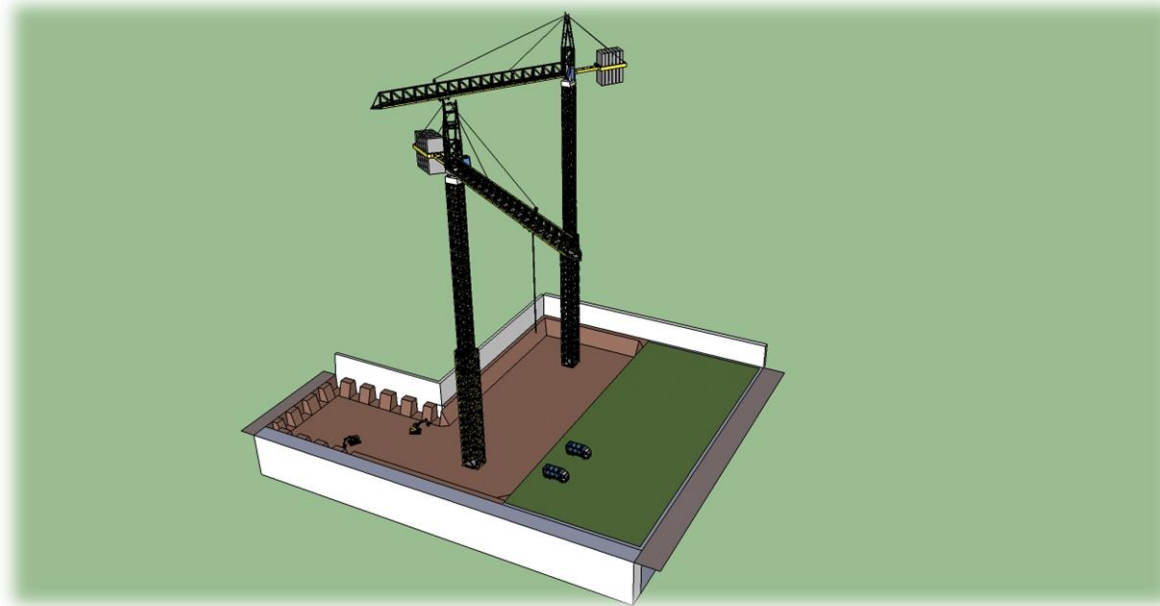
3. COMIENZO DE EJECUCIÓN DE MURO DE SÓTANO CON ZAPATA CORRIDA EN ZONA A Y B POR BATACHES ALTERNOS, Y EJECUCIÓN DE MURO PANTALLA ZONA C.
