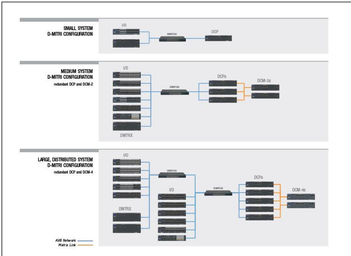
Fig. 5 Sistema de Procesado D-Mitri de Meyer Sound Labs, Inc.
