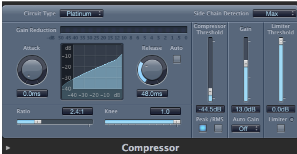
Figura 7.6. El compresor usado para mejorar la dinámica en la grabación „Globos”. Resulto necesario aplicar los ajustes causantes el Gain Reduction de unos 20 dB.
