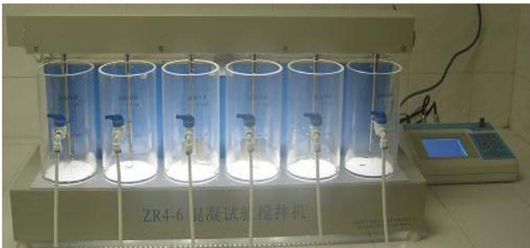
Figura 4.1: Agitador utilizado en el laboratorio.
