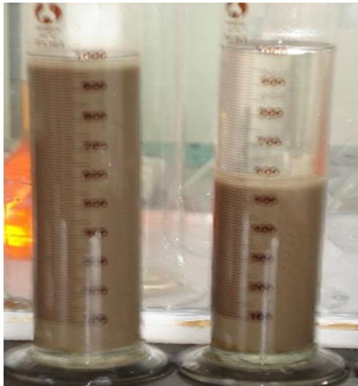
Figura 5.6: Sedimentación del lodo.
