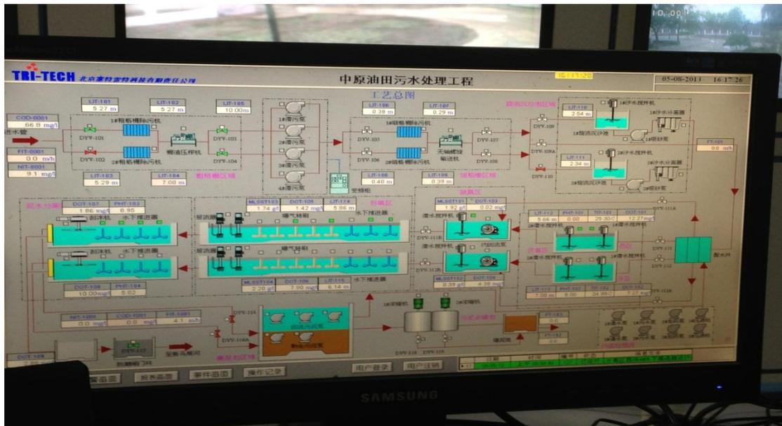
Figura 2.4: Sistema de vigilancia de zanja de oxidación integrada.
