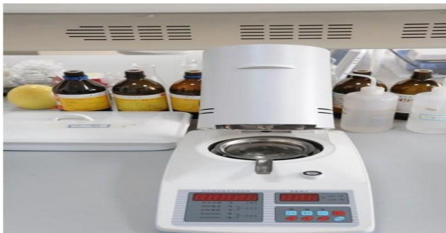
Figura 4.3: Analizador de humedad utilizado en el laboratorio.
