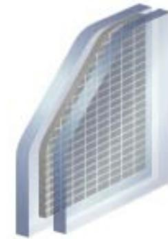
Esquema del vidrio fotovoltaico
