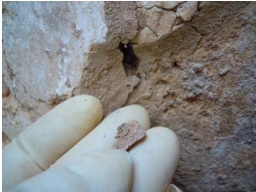
Imagen 3.74. Aspecto del mortero fino y resinoso
