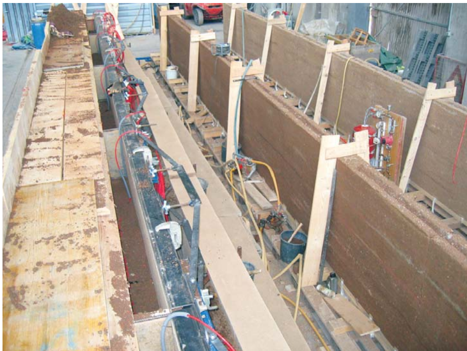
Imagen 2.8; Industria donde se elaboran muros de tapial prefabricados
