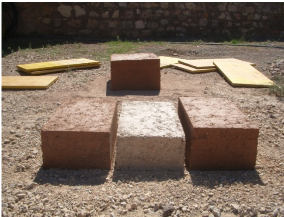
Imagen 2.1. Muestras de Hormigón de Cal para recalce de Cimentación en las Obras del castillo de Sagunto
