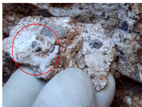
Imagen 3.94. Imagen 3.95: Fragmento que porta inyección de Mortero. Probablemente PLM.
