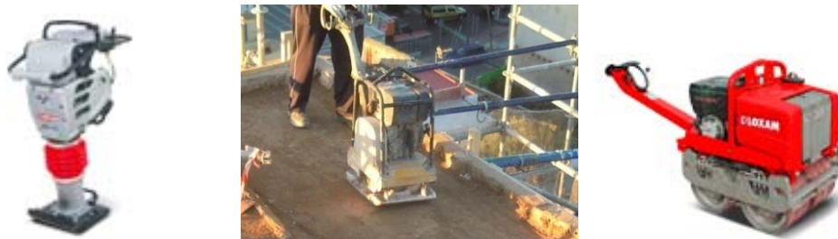
Imagen 2.5. Pisón; Bandeja Vibratoria y Rodillo de Lanza.
