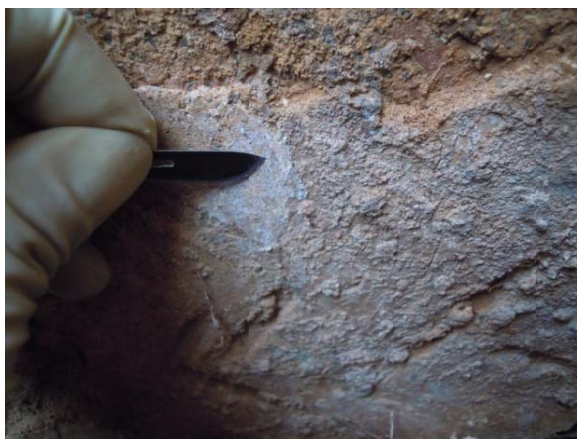
Imagen 3.93. Rascados infructuosos con bisturí sobre resinas epoxis
