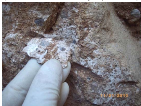
Imagen 3.94. Imagen 3.95: Fragmento que porta inyección de Mortero. Probablemente PLM.
