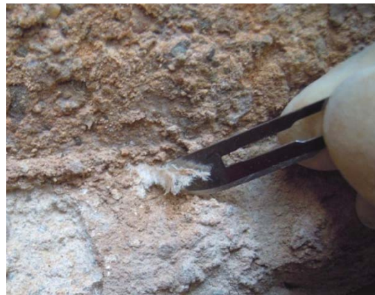
Imagen 3.67. Imagen 3.68. Restos de fibra adheridos
