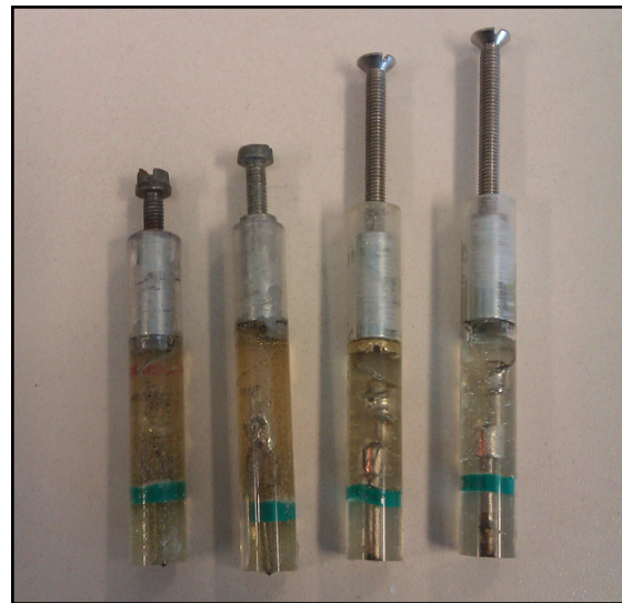
Figura 3.20. Electrodo de hierro con los tornillos enroscados en el casquillo de acero inoxidable.
