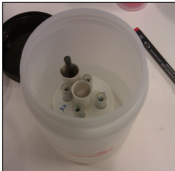
Figura 3.34. Celda de corrosión alojada en un baño de agua destilada en el interior del segundo recipiente.
