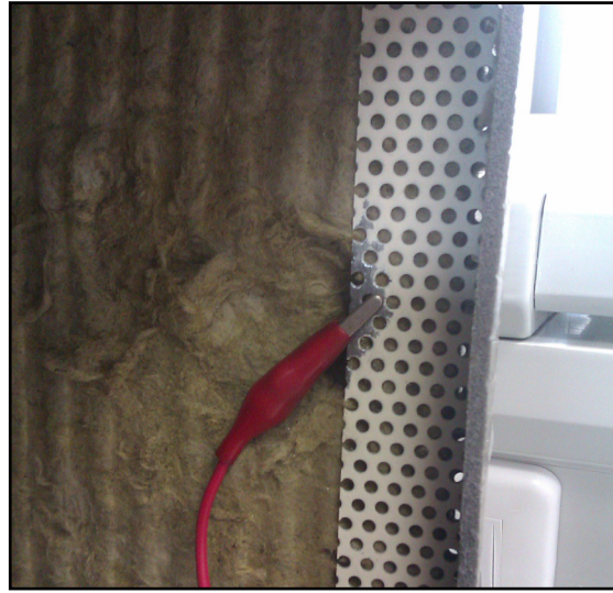
Figura 3.45. Detalle de la conexión de la caja Faraday al conductor de la línea de tierra del potenciostato.
