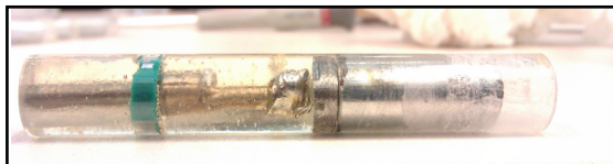
Figura 3.22. Vista lateral de uno de los electrodos de trabajo de hierro totalmente finalizado.
