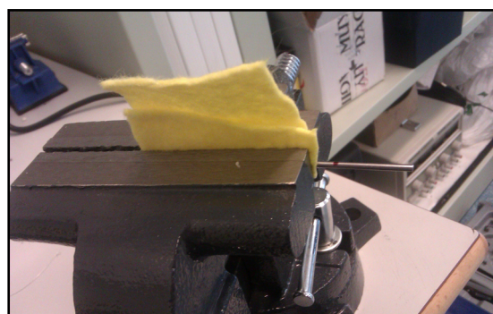
Figura 3.11. Barra de hierro preparada para ser cortada.
