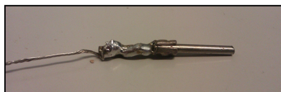
Figura 3.12. Barra de hierro abrazada por conector faston al que queda soldado con estaño el conductor eléctrico desnudo.
