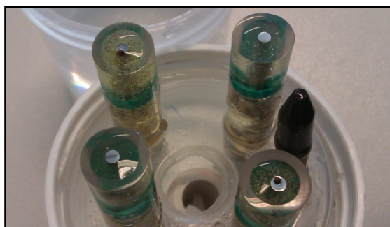
Figura 3.55. Celda de corrosión desmontada tras uno de los ensayos en disolución con Cl - . Se observan dos de los electrodos de hierro atacados por picadura, mientras que los otros han quedado pasivados.
