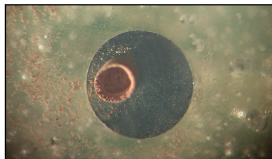
Figura 3.56. Imagen en microscopía óptica de una picadura por cloruros y crecimiento del anillo de óxido en uno de los electrodos de hierro.
