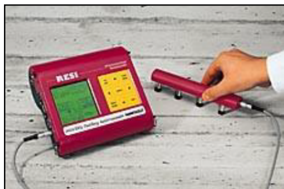
Figura 2.123. Medida de la resistividad del hormigón con conductímetro.
