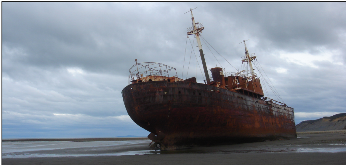
Figura 2.43. Barco encallado en la costa atacado por corrosión marina.
