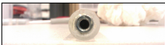
Figura 3.24. Extremo superior de uno de los electrodos de trabajo de hierro donde la rosca del casquillo de acero inoxidable recibe al tornillo de conexión.
