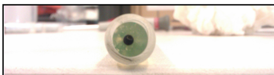
Figura 3.23. Extremo inferior de uno de los electrodos de trabajo de hierro donde queda expuesta la superficie metálica de sección circular.
