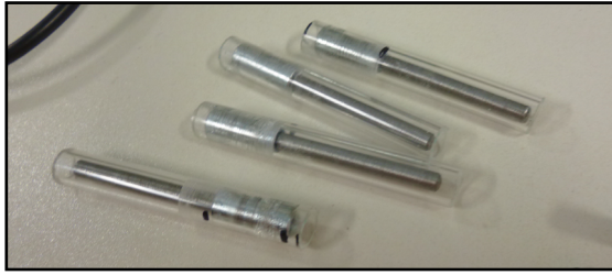
Figura 3.14. Electrodo de acero insertados dentro de la camisa de metacrilato, fabricados para investigación con inhibidores paralela a este estudio.
