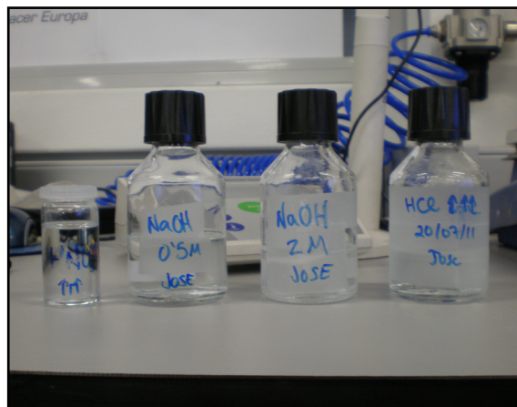
Figura 3.6. Ácidos y bases para ajustar el pH de la disolución. De izquierda a derecha: \text{HNO}_3 , \text{NaOH}(0.5\text{M}) , \text{NaOH}(2\text{M}) , \text{HCl} .
