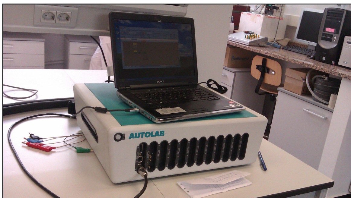
Figura 3.42. Potenciostato marca Autolab conectado a un PC que controla, representa, registra y procesa la señal eléctrica aplicada y la consecuente respuesta de la celda de corrosión.
