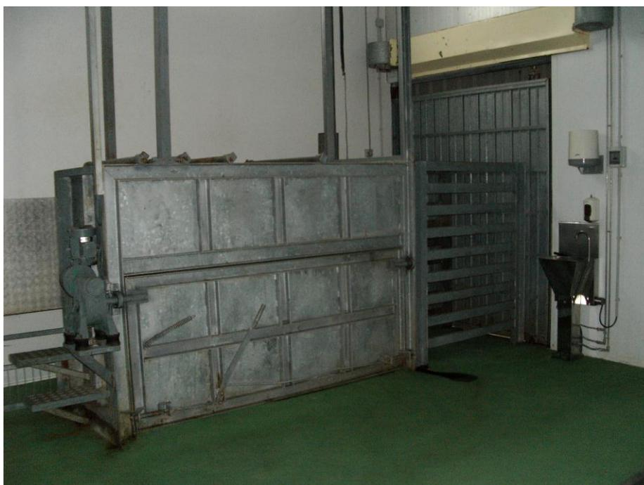
**Imagen 7:** Sistema de sujeción del animal y de aturdimiento.
