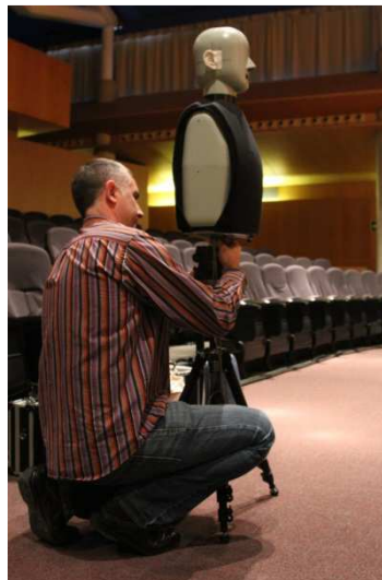
Figura 51. Montaje del maniquí Bruel & Kjaer 4100 para el registro binaural.
