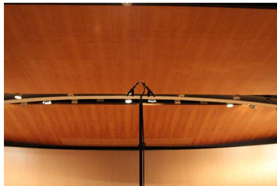
Figura 44. Colocación final del par estéreo.
