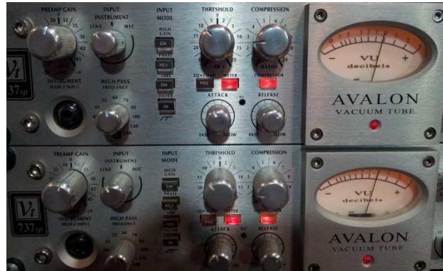
Figura 75. Detalle de los dos Compresores a Válvulas Avalon 737SP.
