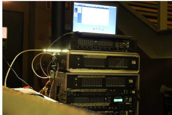
Figura 57. Segundo sistema de grabación sobre las interfaces de audio del sistema principal.
