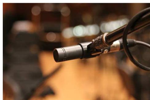
Figura 8. Colocación Neumann KM140.
