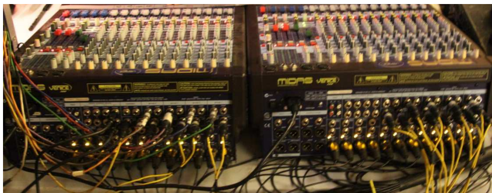
Figura 56. Conexionado de las entradas de micro a los previos de las mesas MIDAS y salidas directas.
