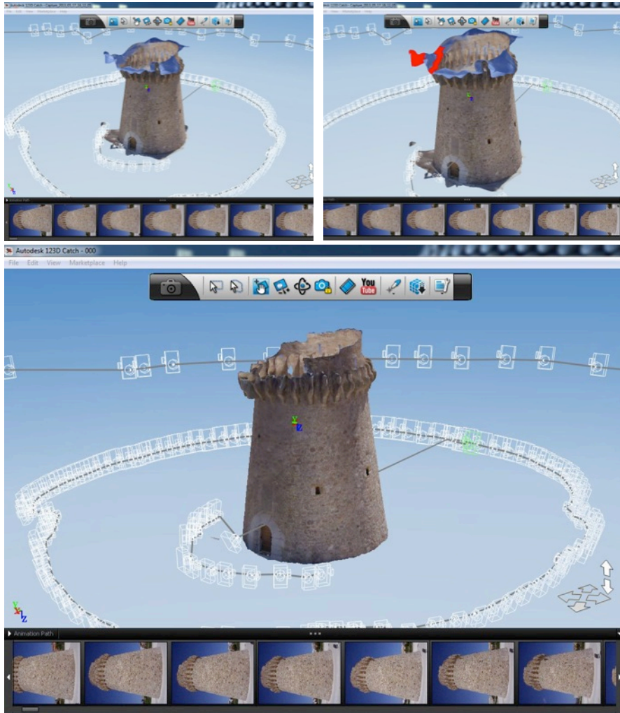
Instantáneas de la secuencia del software 123D Catch. Levantamiento fotogramétrico de la Torre de Piles.
