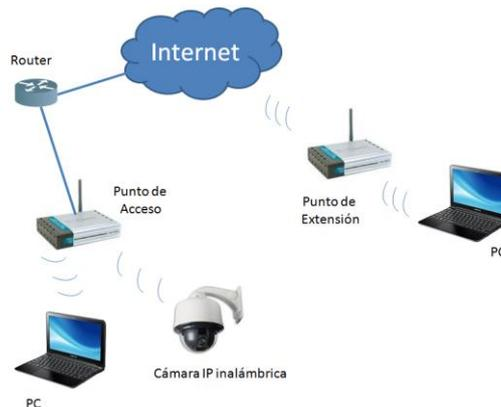
Figura 13. Ejemplo de conexionado de los puntos WIFI
