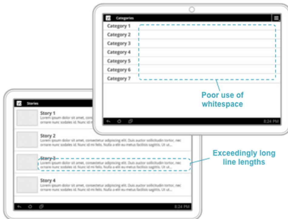
Figura 53 (arriba). Mal uso de los espacios en blanco para el diseño de la UI.
