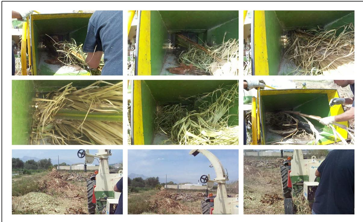
Figura 4.8. Trituradora manual de tolva grande con cuchillas.
