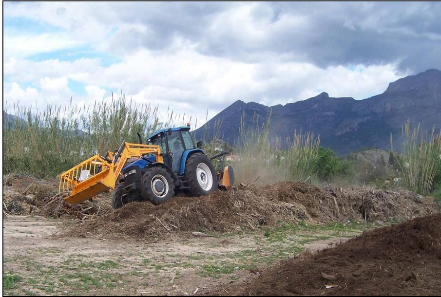
*Figura 4.3. Triturado de la Pila 3 con la trituradora de martillos acoplada al tractor New Holland.*
