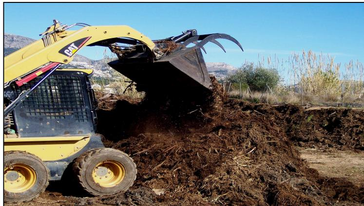
Figura 3.5. Mini excavadora para montar las pilas.
