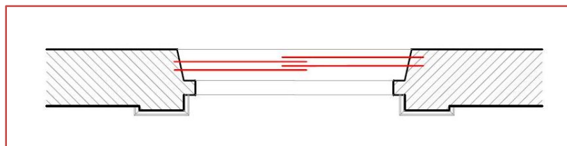
Fig. 80 – Detalle de armado de fibra de vidrio
