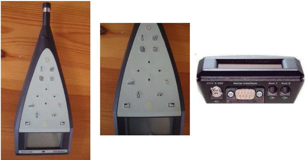
Figura 20: Sonómetro integrador Brüel & Kjaer Mediator 2238
