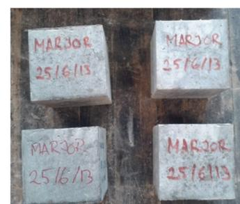
Las probetas no se introdujeron en cámara ya que la viga no iba a ser introducida y deseábamos obtener resultados comparables en igualdad de condiciones de curado. A continuación se limpiarán todas las herramientas y moldes utilizados y se tapaná la viga y las probetas con un plástico (ver fotografía 4.144).
