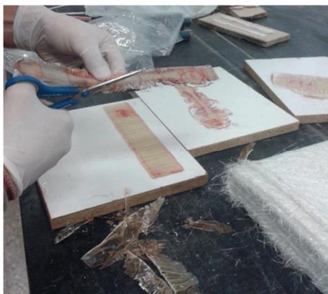
Fotografía 4.37. Desbardado de probetas
