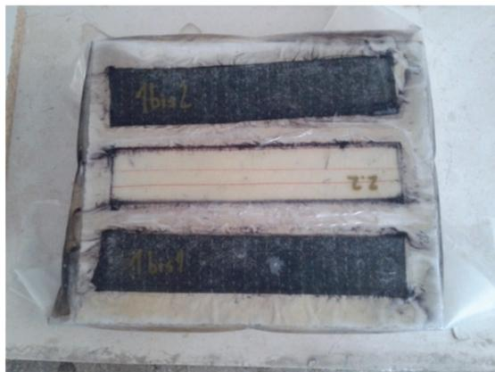
Fotografía 4.62. Probetas tras post-curado
