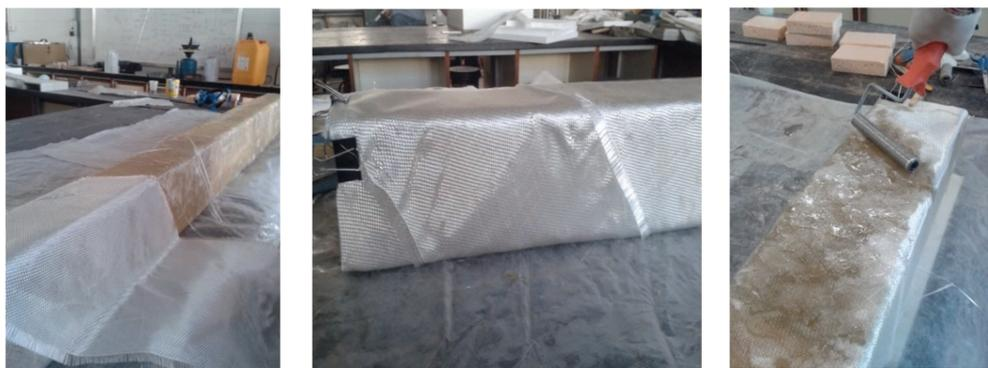
Fotografía 4.109., 4.110. y 4.111. Preparación, colocación e impregnación de tercera capa de Tejido\_0/90 a 45°
