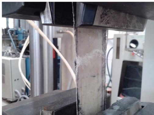
*Fotografía 4.65. Ensayo probeta con extensómetro*    *Fotografía 4.66. Probeta ensayada a tracción*
