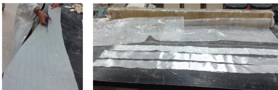
Fotografía 4.112. y 4.113. Corte y preparación del laminado
