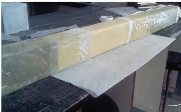
*Fotografía 4.88. Unión central con perfil pultrusionado como molde*
