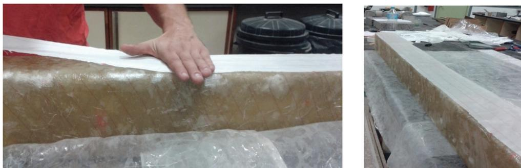
Fotografía 4.114. y 4.115. Colocación de primera lámina de la zona a compresión de la viga
