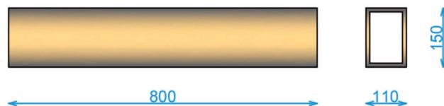
Figura 4.4. Perfil pultrusionado
