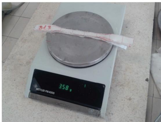
Fotografía 4.26. Peso probetas con balanza electrónica
