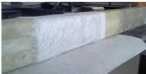
*Fotografía 4.90. Solape de los dos módulos*
