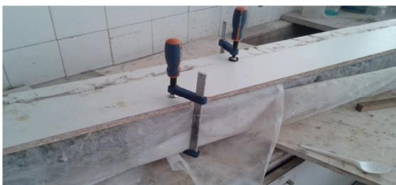
Fotografía 4.121. Prensa del laminado con tablas
