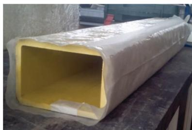
Fotografía 4.80. Incorporación de plástico al perfil pultrusionado
