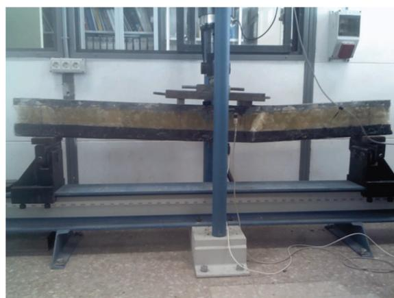
Fotografía 4.148. Rotura viga tras ensayo a flexión
