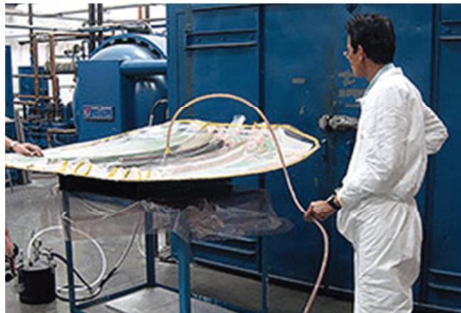
*Fotografía 2.14. Preimpregnado sin autoclave (www.airtechintl.com)*
