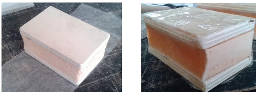
Fotografía 4.97. Mat envolviendo rigidizadores      Fotografía 4.98. Impregnación con resina
