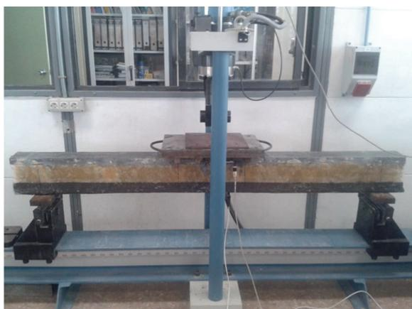
Fotografía 4.147. Ensayo a flexión de la viga
