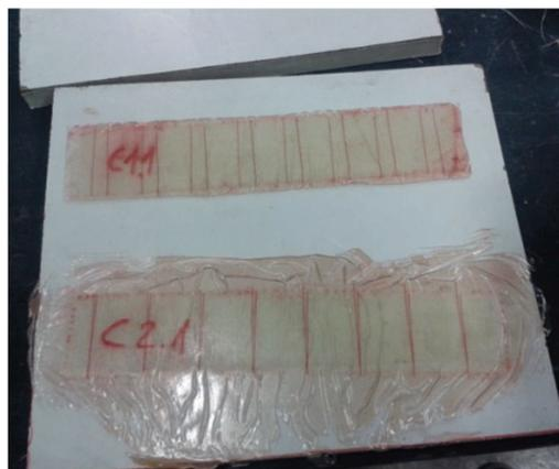
Fotografía 4.38. Probetas tras desbardado
