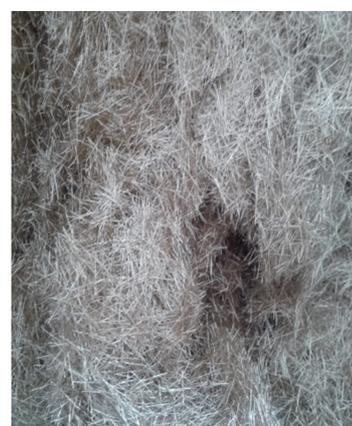
Fotografía 4.133. y 4.134. Amasado del hormigón      Fotografía 4.135. Fibras metálicas
