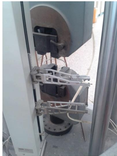
Fotografía 4.14. Maquinaria ensayo tracción      Fotografía 4.15. Captador de deformación
