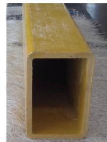
Fotografía 4.18. Sección molde pultrusionado
