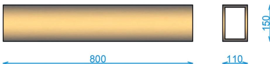
Figura 3.4. Perfil pultrusionado. Molde de la viga
