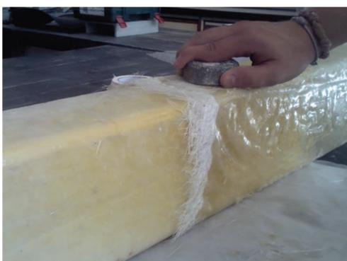
*Fotografía 4.89. Lijado en la parte de los solapes*
