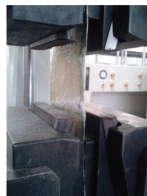
Fotografía 4.43 y 4.44. Máquina de ensayo a tracción
