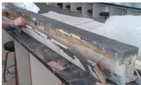
Fotografía 4.142. Viga hormigonada sin encofrado
