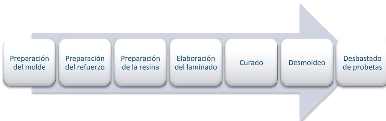
Antes de proceder a cualquier paso en la elaboración de los laminados, es necesario conocer y estudiar a qué ensayos se someterán, con el fin de establecer dimensiones normalizadas. Los compuestos serán sometidos a ensayos de tracción, por lo tanto, la Norma UNE-EN ISO 527, nos diferencia entre tres tipos de probetas: tipo 1B (*ver figura 4.1*), tipo 2 (*ver figura 4.2*) y 3.
