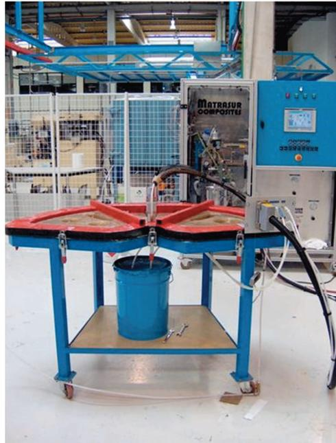
*Fotografía 2.22. Moldeo de transferencia de resina (www.directindustry.es)*
