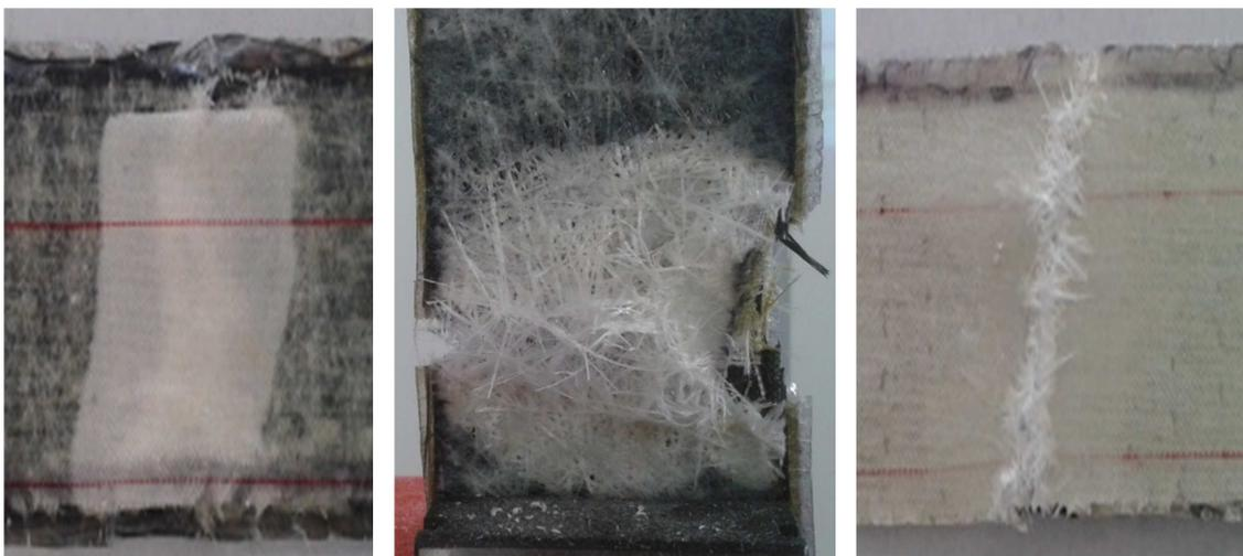
*Fotografía 5.5 Diferentes roturas de los laminados*
