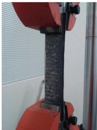
*Fotografía 4.77. Maquinaria ensayo a tracción    Fotografía 4.78. Probeta a ensayar*
