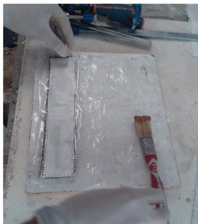
Fotografía 4.31. Colocación láminas
