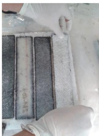
*Fotografía 4.73. Colocación lámina final tipo MAT*
