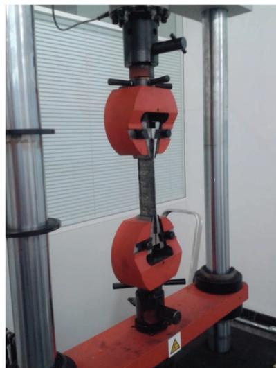
Fotografía 4.16. Maquinaria ensayo tracción
