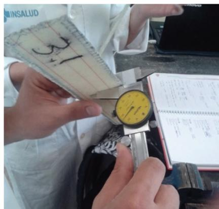
Fotografía 4.64. Comprobación espesor probetas
