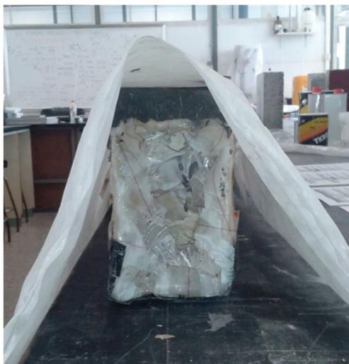
Fotografía 4.144. Colocación de plástico cubriendo la viga
