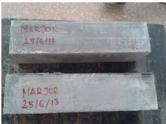
Fotografía 4.145. Probetas para ensayo a flexión
