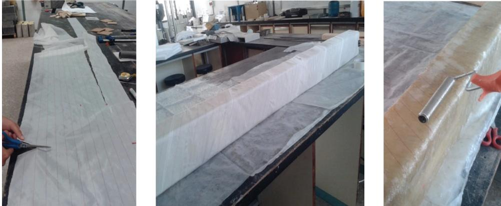
Fotografía 4.106., 4.107. y 4.108. Preparación, colocación e impregnación de segunda capa de Plain\_0/90 a 45°
