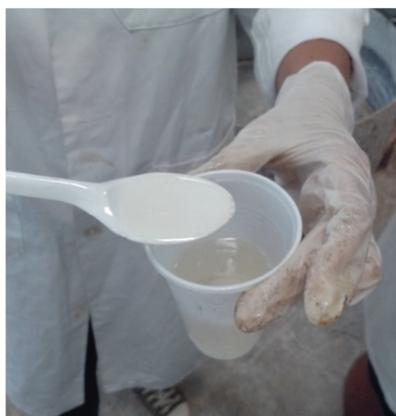
Fotografía 4.69. Homogeneización resina epoxi-catalizador
