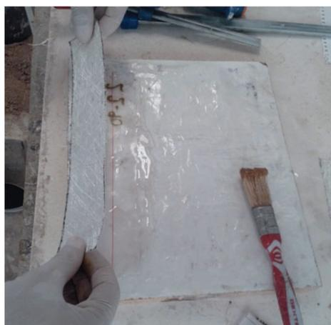
*Fotografía 4.54. Colocación láminas*
