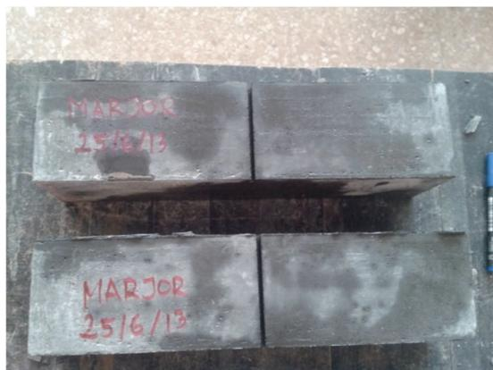
Fotografía 4.146. Probetas hormigón con entalla
