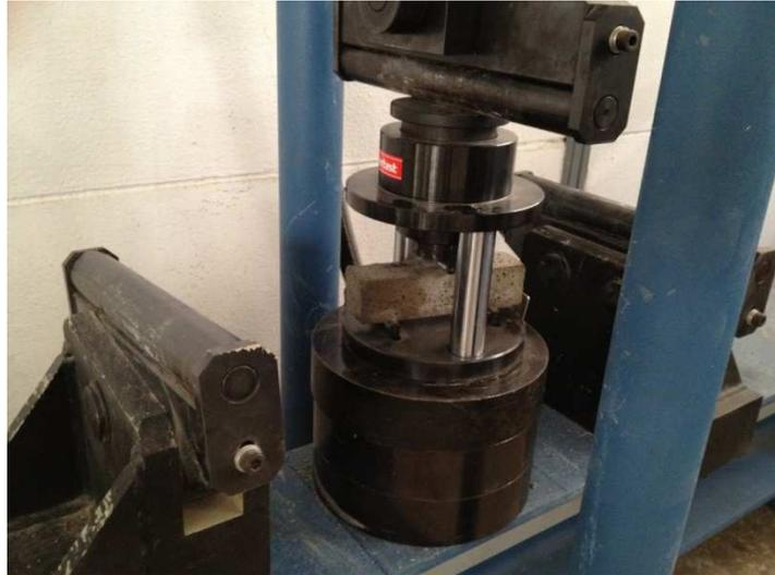
**Imagen 5.22 Ensayo a flexión**
