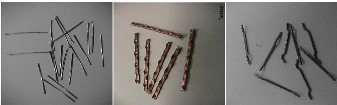
**Imagen 3.3: Diferentes formas de fibras metálicas. (HRF A. Aguado) [10]**
