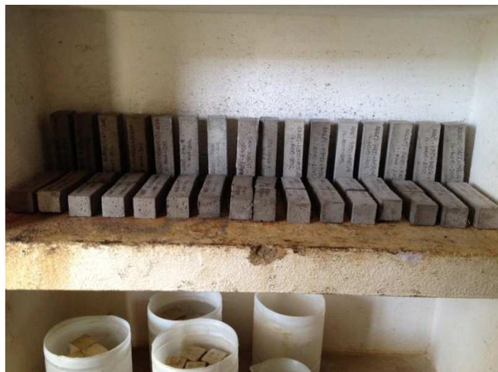
**Imagen 5.27 Probetas en Cámara Húmeda**
