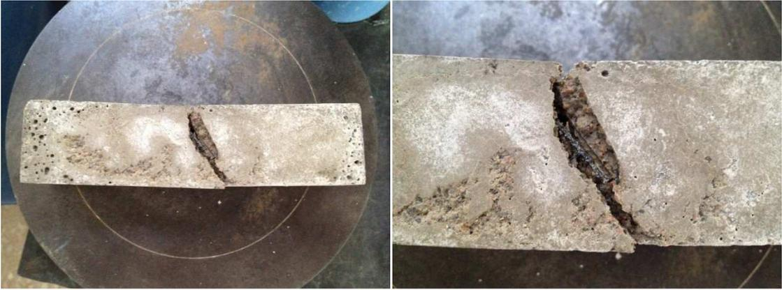
**Imagen 5.34 Probeta rota tras ensayo a Flexión**
