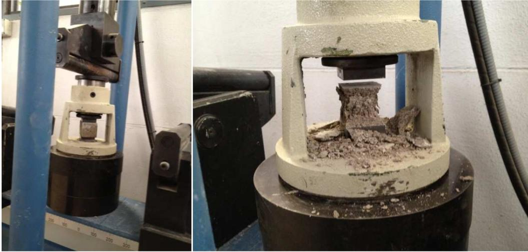
**Imagen 5.25, 5.26 Ensayo a compresión**
