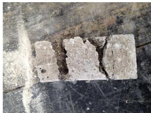
b) Probeta tras ensayo a compresión
