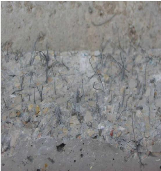
**Imagen 1.8 Hormigón con fibras. (ItalcementiGroup) [5]**
