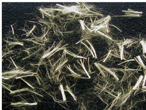
**Imagen 3.8 Fibras poliméricas en multifilamentos.**
