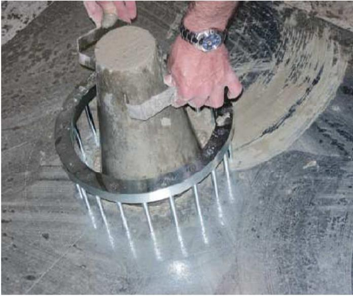
**Imagen 3.17 Método Ensayo Anillo Japonés**
