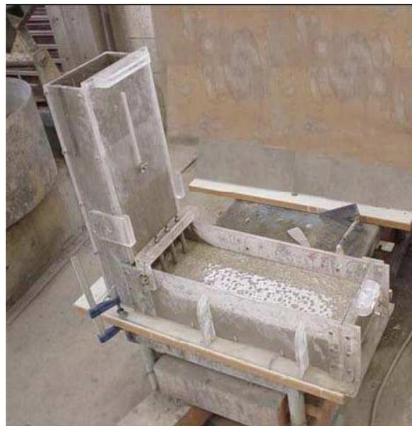
La norma española, UNE 83363 define la utilización de 3 barras de 12mm de diámetro para ensayar hormigones con diámetro máximo de árido igual a 20mm, y, 2 barras de 16mm de diámetro para hormigones con diámetros máximos de árido superior a 20mm.
