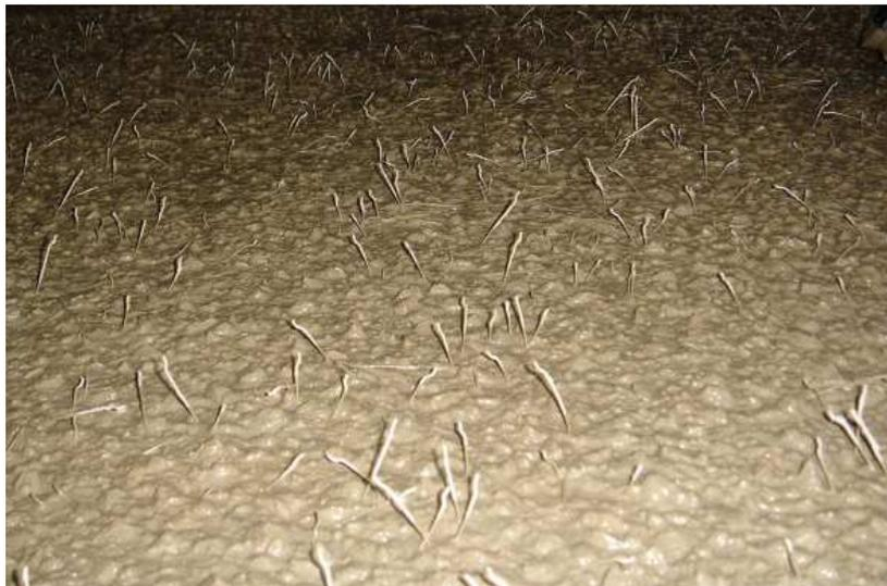
**Imagen 3.10 Hormigón con fibras poliméricas (HRF. A. Aguado) [10]**
