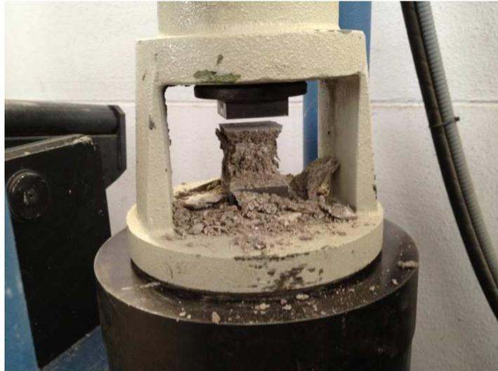
**Imagen 5.30 Ensayo a Compresión**
