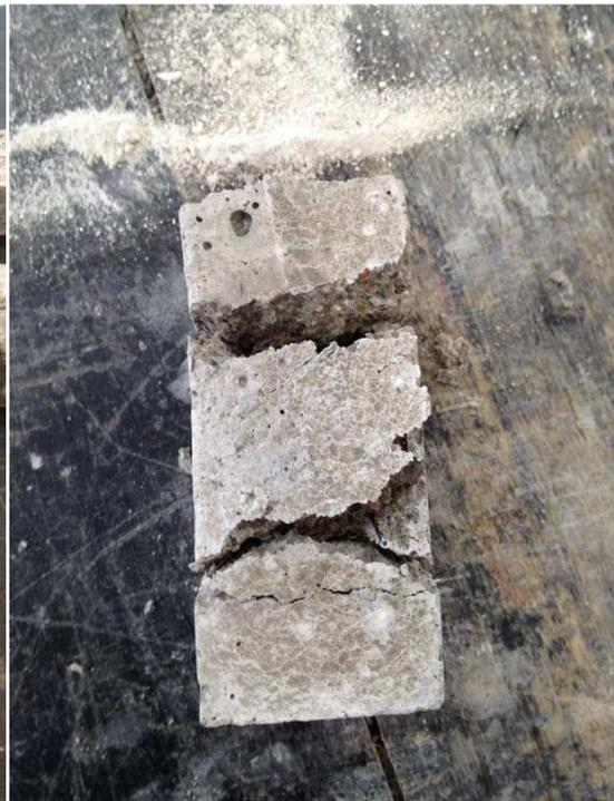
Imagen 5.29 Probetas rotas a compresión
