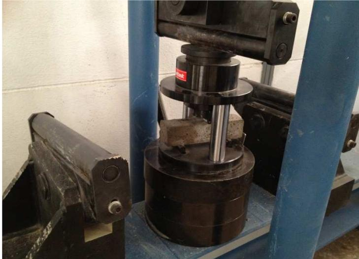
**Imagen 5.32 Ensayo a Flexión**
