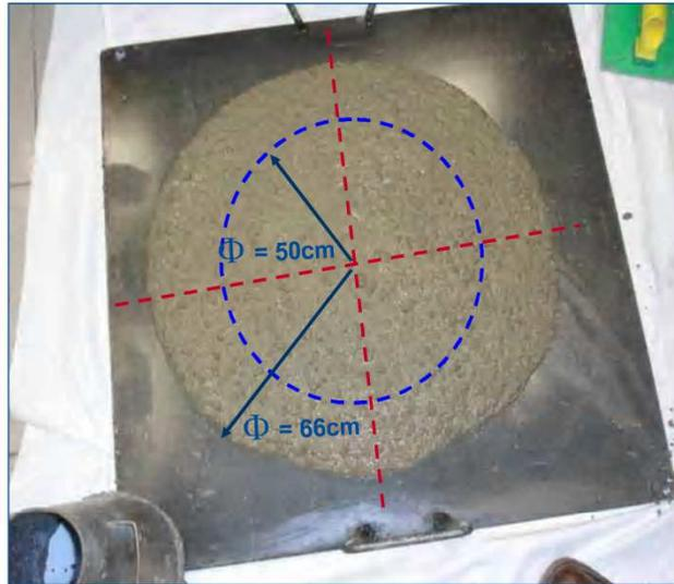
En la siguiente imagen (img.3.14), se observa la realización de este ensayo, el de escurrimiento, se ve como se vierte el hormigón autocompactante en el cono de Abrams, situado sobre una plataforma metálica totalmente lisa.
