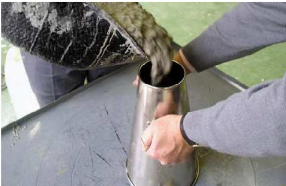
**Imagen 3.14 Método de ensayo Escurrimiento**
