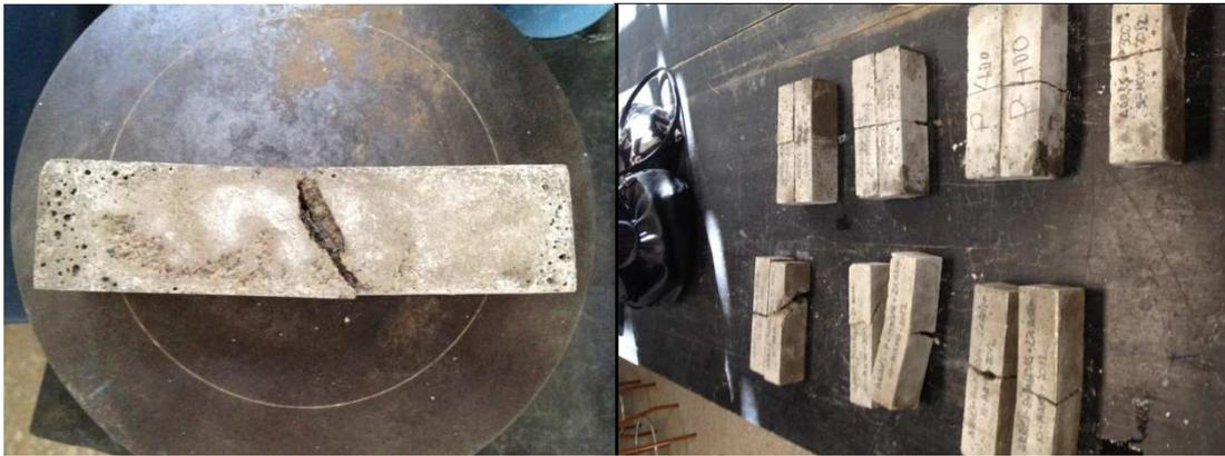
**Imagen 5.23, 5.24 Probetas ensayadas a flexión**
