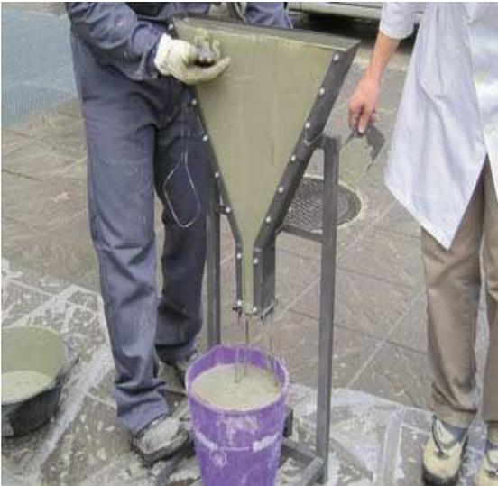
**Imagen 3.23 Ensayo Embudo V**
