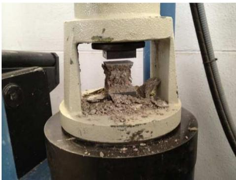
Imagen 6.1 a) Ensayo a compresión
