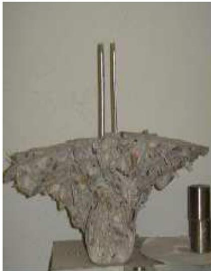
**Imagen 1.11 Trozo de placa de contención de tierras. Hormigón con fibras. (A. Aguado) [7]**
