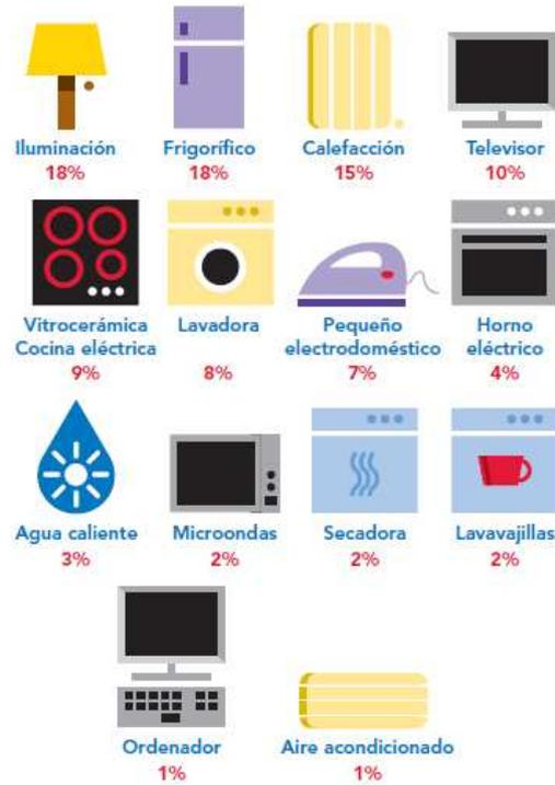
Figura 23: Consumo de energía de los equipos de suministro eléctrico de la vivienda.
