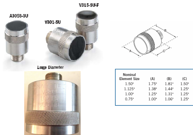
Figura 51: Detalle y especificaciones del transductor Parametrics V392-SU
