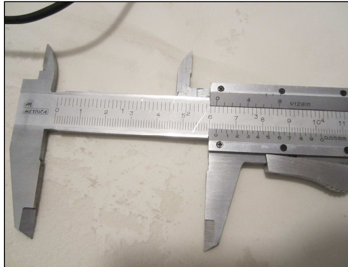
Figura 29: Detalle del calibre utilizado en la medida de la distancia entre el transductor piezoeléctrico y el fondo del recipiente de vidrio.
