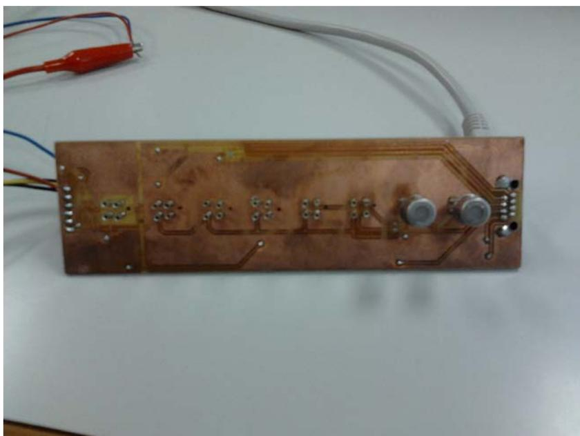
**Figura 12:** Tarjeta de conexión y acondicionamiento de sensores
