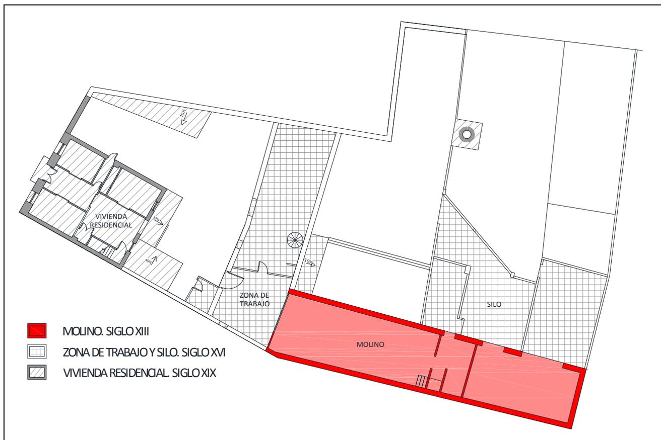
*Evolución de la construcción y ampliación del Molino del Real.*
