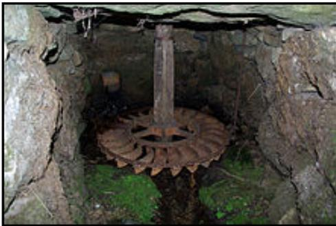
*Sistema impulsor horizontal de un molino Hidráulico.*
