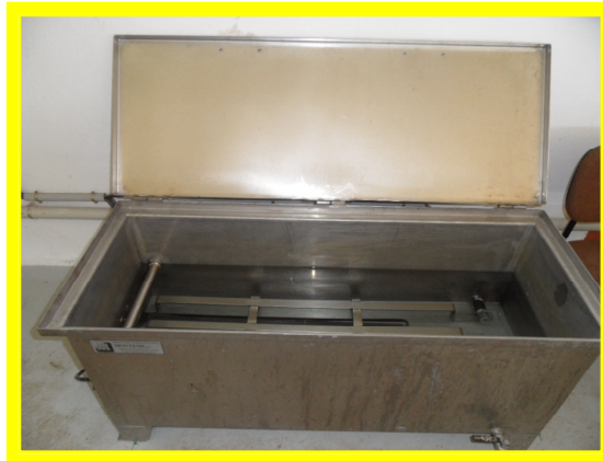
Foto 7. Bañadora para el tratamiento en poscosecha de frutos en la planta piloto del IVIA (Moncada, Valencia)
