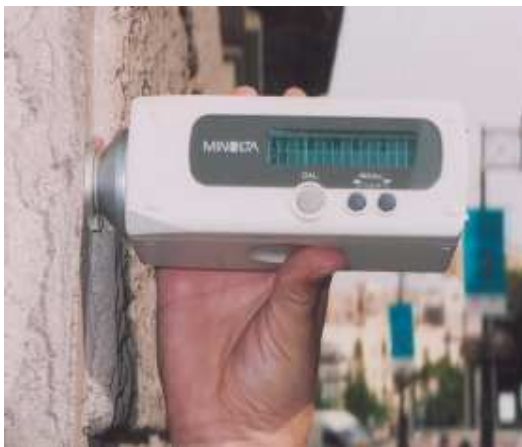
Medición in-situ con colorímetro de contacto
