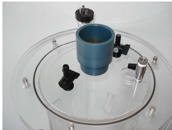
Figura 3.12. Cierre hermético de los reactores. Detalle de la tapa y del sello hidráulico.
