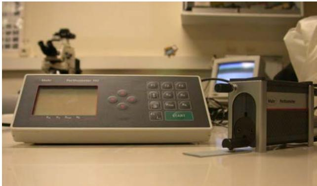
Figura 39. Imagen del Rugosímetro Mahr Perthometer M2 utilizado para la determinación de texturas superficiales.
