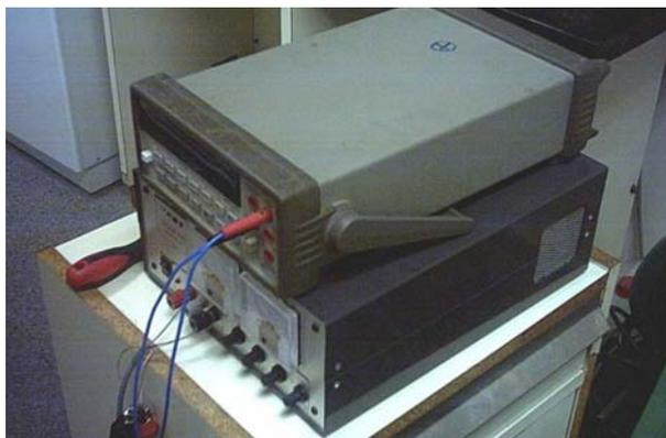
Figura 28. Multímetro utilizado para registrar la señal eléctrica de la célula de carga
