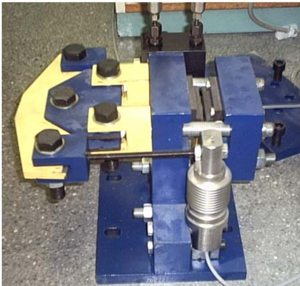
Figura 26. Maquina multifriccion diseñada
