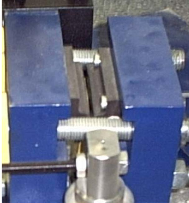
Figura 29. Mordazas plano-plano incorporadas en el equipo multifricción
