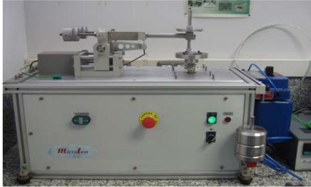
Figura 35. Vista general del Equipo Pin-on-disk utilizado
