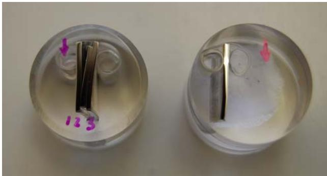
Figura 17. Preparación de las probetas para la obtención y medidas del espesor de recubrimiento.
