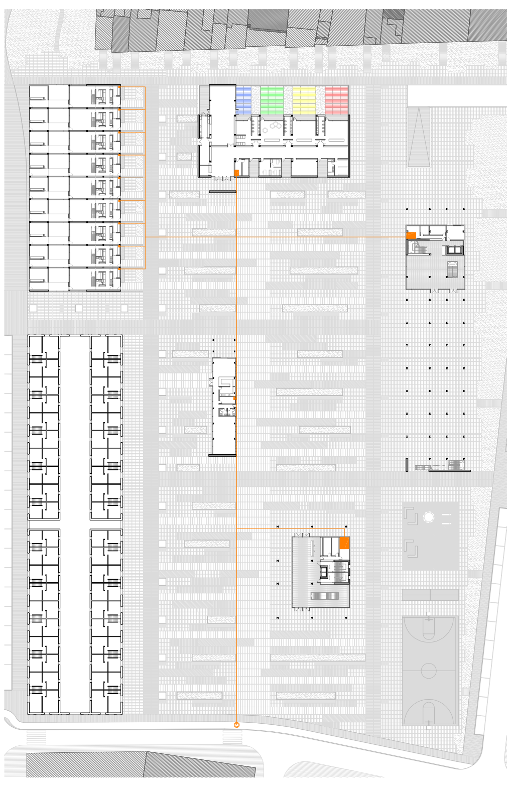
Acometida y cuartos de contadores. Planta cota 0
